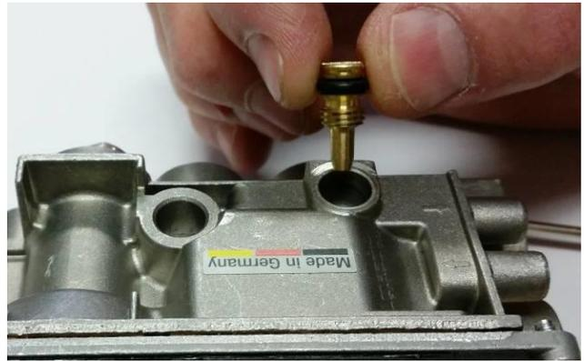
Figure 24 – Enlèvement de la Vis de Basse Pression GN
