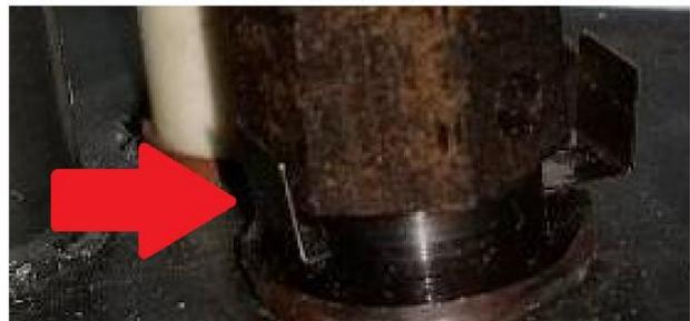
**Figure 28 – Serrage de la Tour et Glissement de la Barrière de la Veilleuse Derrière la Tour de la Veilleuse (position GP)**
